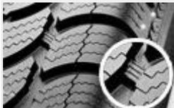
Al verificar la presión de los neumáticos, también es necesario verificar el desgaste de la banda de rodamiento. Los indicadores TWI se ubican en los flancos de los neumáticos y sirven para localizar los testigos de desgaste. El desgaste no debe alcanzar jamás los indicadores ubicados en el fondo de las esculturas y debe permanecer uniforme en toda la superficie. "El testigo de desgaste de 1.6 milímetros indica la altura de goma mínima legal".
